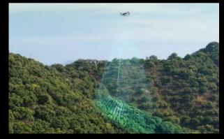
El DJI AGRAS T50 admite la detección de obstáculos y el seguimiento del terreno para la supervisión [2] de huertos en pendientes de hasta 20° [5] . Con DJI RC Plus y sus capacidades de mapeo en tiempo real, puede identificar automáticamente árboles frutales y obstáculos. En función de la distribución de los árboles frutales, puede generar rutas de vuelo 3D precisas y completamente automáticas.
