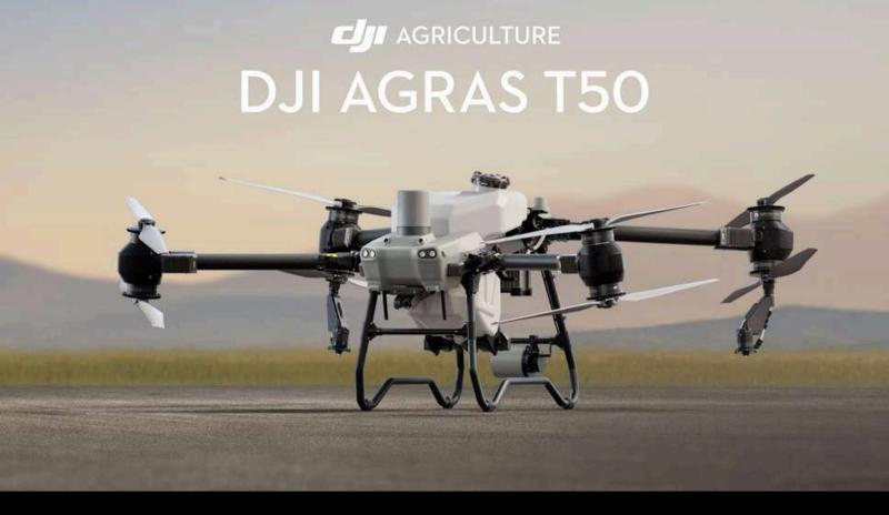
EL DJI AGRAS T50 ELEVA LAS OPERACIONES AGRÍCOLAS CON DRONES A NUEVAS ALTURAS. HEREDA UN POTENTE SISTEMA DE PROPULSIÓN COAXIAL DE DOBLE ROTOR Y UNA ESTRUCTURA RESISTENTE AL PAR DE TORSIÓN DE TIPO DIVIDIDO PARA UNA ESTABILIDAD DE NIVEL SUPERIOR AL TRANSPORTAR CARGAS ÚTILES DE PULVERIZACIÓN DE 40 KG [1] O DE ESPARCIMIENTO DE 50 KG [1].
