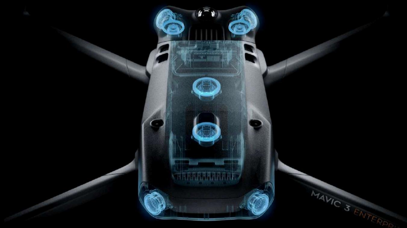
Equipado con lentes gran angular en todos los lados para evitar obstáculos omnidireccionales sin puntos ciegos. Ajuste las alarmas de proximidad y la distancia de frenado según los requisitos de la misión.
